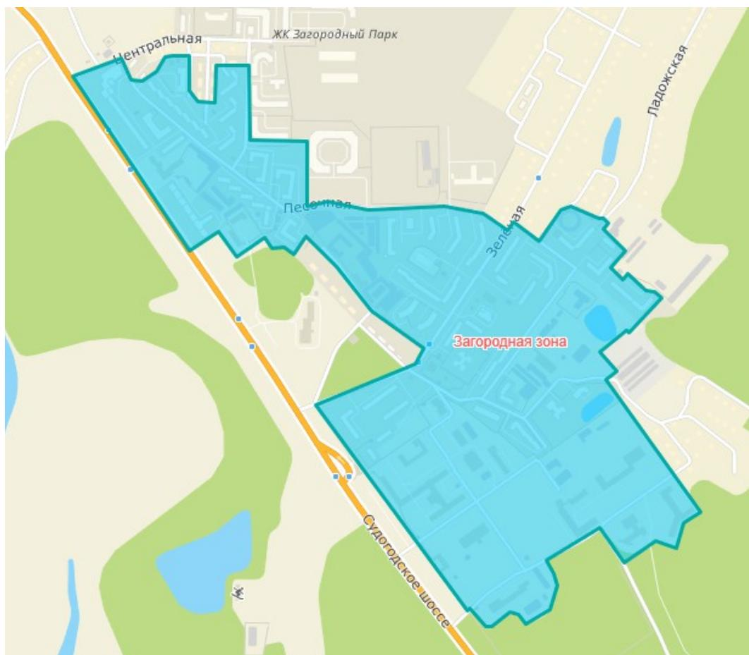
Рисунок 30 – Границы системы теплоснабжения котельная Загородная зона
