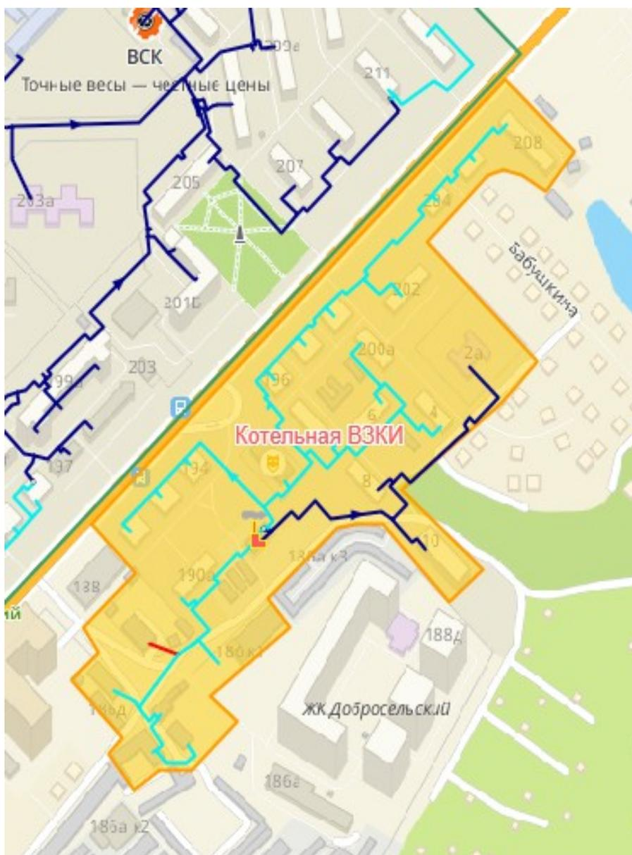
Рисунок 10 – Границы системы теплоснабжения котельная ВЗКИ
